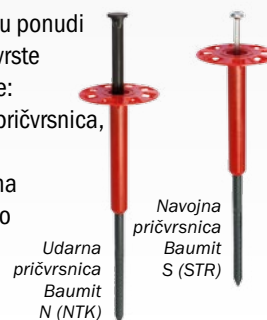
Baumit prva StarTrack pričvrsnica se postavlja na udaljenosti od 10 cm od ugla, mjereći vertikalno i horizontalno, pa potom svaka sljedeća na svakih 40 cm
