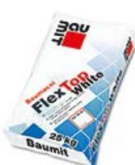
Bijelo visokofleksibilno, tankoslojno ljepljivo (C2TE S1, EN 12004, EN 12002), otporno na smrzavanje, stabilno. Naročito prikladno za podno grijanje, pločice velikog formata i kod prepločavanja pločica na pločicu.
