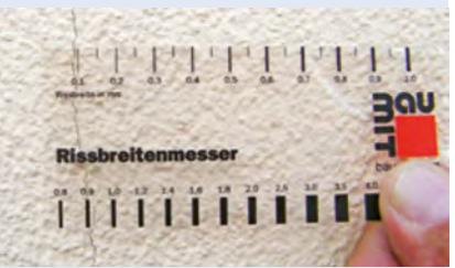
Za mjerjenje kretanja pukotina u liniji koristi se tzv. stakleni špijun na način da se preko pukotine postavi staklena pločica, a mjerilo pukotine pokazuje opseg deformacije.
