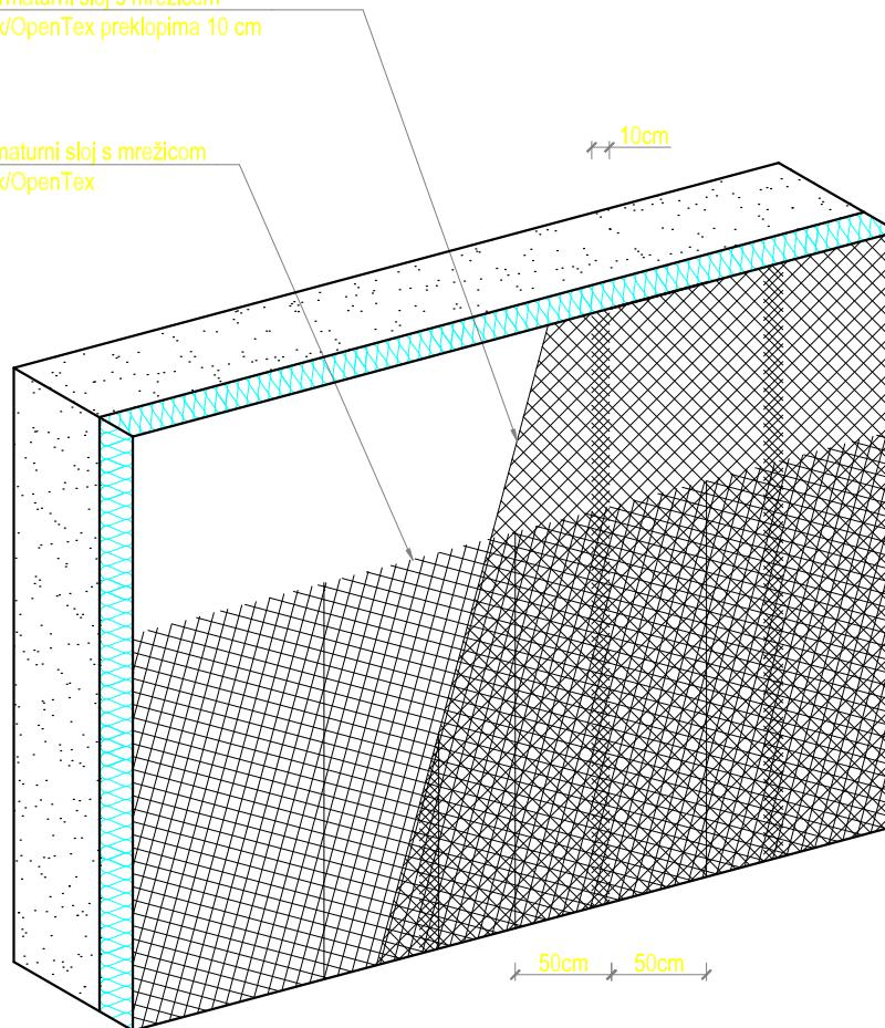
U slučaju dvostrukog armiranja, minimalna debљina armaturnog sloja treba biti veća od 5 mm. Prvi sloj mrežice se ugrađuje u svježi mort bez preklapanja (tupi sloj), a nakon što prvi sloj dovoljno očvrste, u svježi naneseni sloj morta se utopi drugi sloj mrežice. Obavezni prekop mrežica prvog i drugog sloja je s pomakom od 1/2 širine mrežice.
