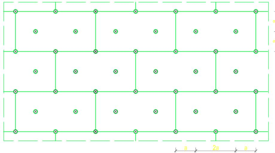
Prčvrsnice se smiju postaviti tek kad ljepilo očvrstne (u pravilu nakon dva do tri dana) odnosno prema tehničkoj uputi. Prčvrsnice treba postaviti tako da je gornja površina rozete u istoj ravni s površinom ploče/lamele, uz napomenu da ovo ne vrijedi kad je rozeta upuštena u toplinsko izolacijsku ploču. Upotreba pričvrsnica ne smije uzrokovati deformacije i dizanje ploča. Duljina pričvrsnica određuje se ovisno o vrsti podloge, debljini toplinske izolacije s dubinom sidrenja minimalno 25 mm.
