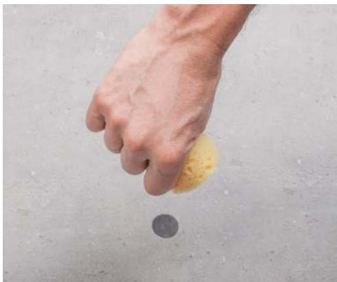
Jednostavni test upojnosti podloge
